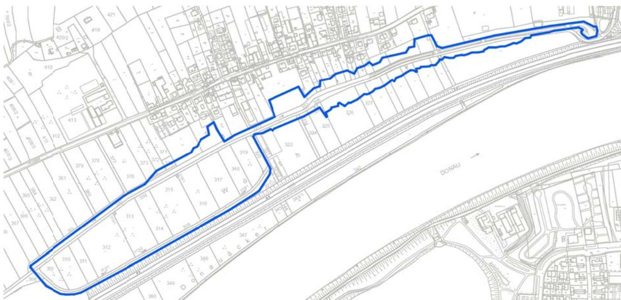
Abbildung 5.11 Einstaufläche im Polder bei einem Wasserspiegel von 332,0 m üNN
