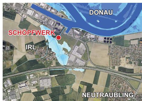
Abbildung 2: Ausbreitung des 100-jährlichen Hochwassers mit Schöpfwerkschutz
